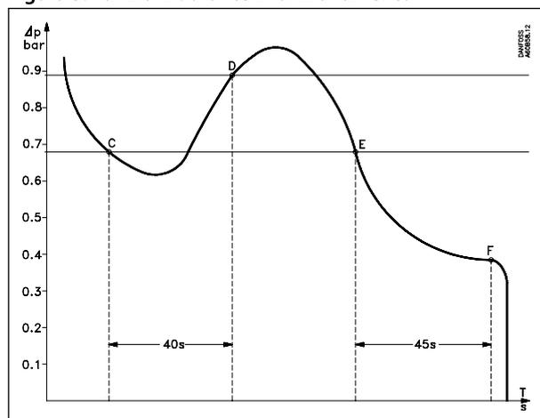
**Posizione C:** la pressione dell'olio di lubrificazione scende durante il funzionamento a un valore inferiore a quello del differenziale impostato o fisso. Al punto C, il circuito di sicurezza T1-T2 si chiude attivando il timer.
