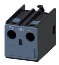
blocchetto di contatti ausiliari, sul lato frontale, 1 NO, 73/74, via di corrente: 1 NO, ingresso cavi dall'alto, morsetti a vite, per contattori 3RT2 e contattori ausiliari 3RH2
