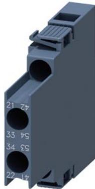
blocchetto di contatti ausiliari, laterale, 1 NO + 1 NC, a sinistra: 41/42, 53/54, a destra: 21/22, 33/34, via di corrente: 1 NC, 1 NO, morsetti a vite, per contattori 3RT2.1
