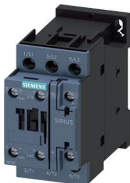
contattore di potenza, AC-3e/AC-3, 32 A, 15 kW / 400 V, a 3 poli, AC 230 V, 50/60 Hz, contatti ausiliari: 1 NO + 1 NC, morsetti a vite, grandezza costruttiva: S0
