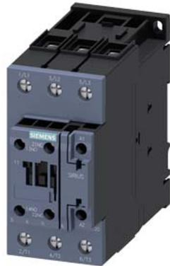
contattore di potenza, AC-3e/AC-3, 51 A, 22 kW / 400 V, a 3 poli, AC 24 V, 50/60 Hz, contatti ausiliari: 1 NO + 1 NC, morsetti a vite, grandezza costruttiva: S2
