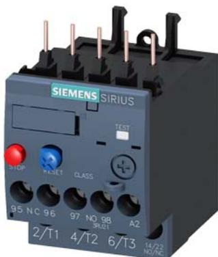
relè di sovraccarico 4,5...6,3 A termico per protezione motore grandezza costruttiva S00, CLASS 10 montaggio su contattore circuito principale: morsetti a vite circuito ausiliario: morsetti a vite reset manuale-automatico
