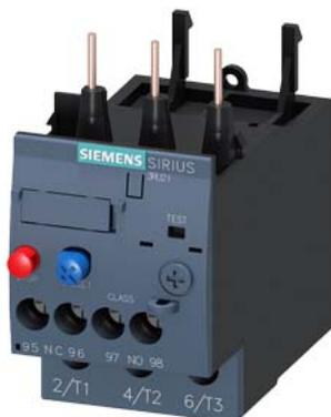
relè di sovraccarico 14...20 A termico per protezione motore grandezza costruttiva S0, CLASS 10 montaggio su contattore circuito principale: morsetti a vite circuito ausiliario: morsetti a vite reset manuale-automatico
