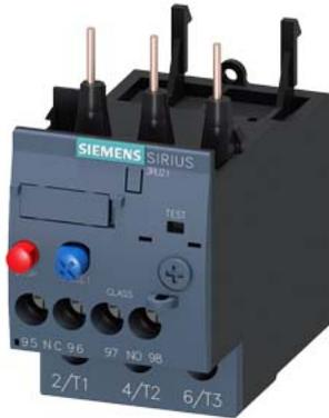
relè di sovraccarico 20...25 A termico per protezione motore grandezza costruttiva S0, CLASS 10 montaggio su contattore circuito principale: morsetti a vite circuito ausiliario: morsetti a vite reset manuale-automatico
