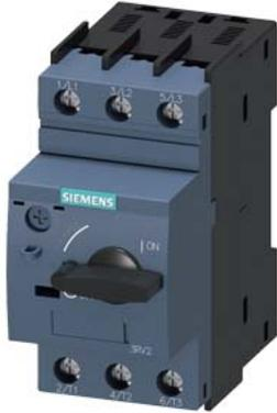
interruttore automatico grandezza costruttiva S00 per protezione motore, CLASS 10 sganciatore A 1,1...1,6 A sganciatore N 21 A morsetto a vite potere di manovra standard
