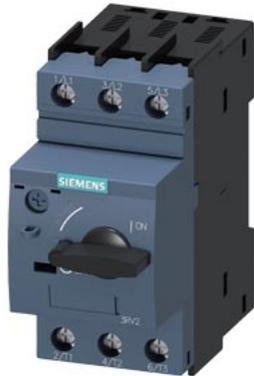
interruttore automatico grandezza costruttiva S0 per protezione motore, CLASS 10 sganciatore A 18...25 A sganciatore N 325 A morsetto a vite potere di manovra standard
