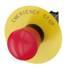
pulsante a fungo di ARRESTO DI EMERGENZA, 22 mm, rotondo, in plastica, rosso, 40 mm, permanente con blocco positivo, a norma DIN EN ISO 13850, sblocco a rotazione, con disco targhetta giallo, iscrizione: EMERGENCY STOP, con supporto, 1 NC, morsetto a vite
