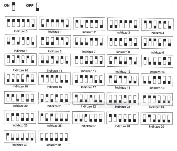
N.B. Impostare il ponticello n°6 in posizione ON solamente nell'ultimo modulo che completa la serie di strumenti ovvero dove terminano i collegamenti.
